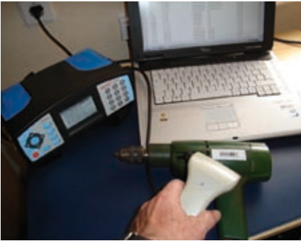
Bild 3: Rechnergestützter Prüfplatz mit Barcode-Scanner
